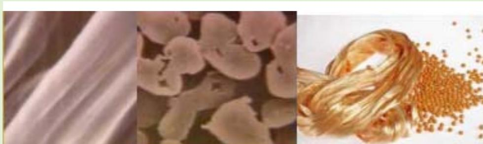
*Figura 3: Vista Longitudinal, seção transversal e fibras de SPF (FALCETTA, 2004).*
